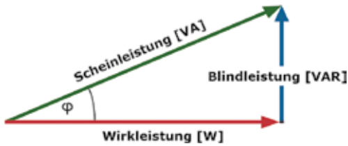
Abb. 3 Phasenwinkel zwischen Strom und Spannung
