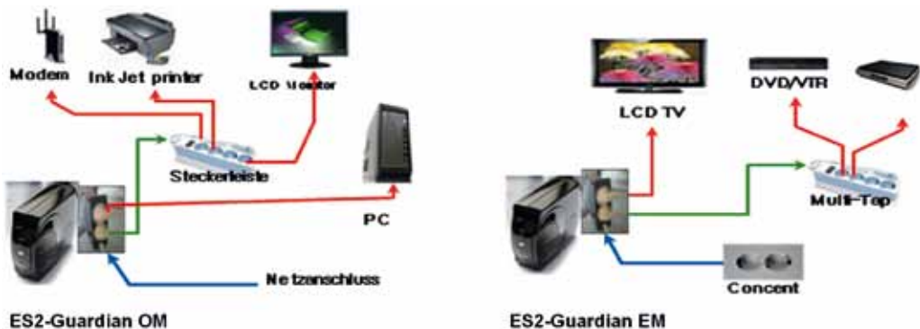
Abb. 2: Der ES2-Energiemanager in typischer Anwendung zum Stromsparen bei PC und TV
